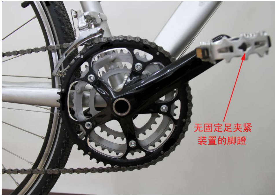
图六：不符合国标 GB3565-2005 链罩条款规定产品示意图
