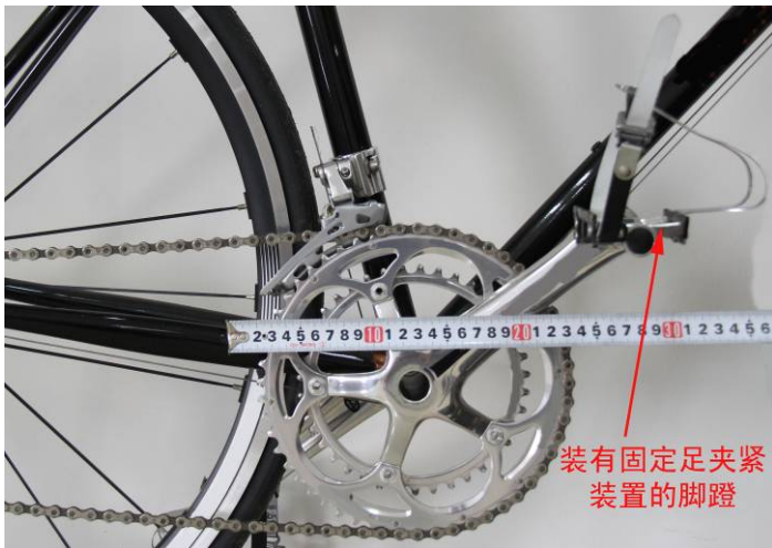
图五：符合国标 GB3565-2005 中 14.4 产品示意图
