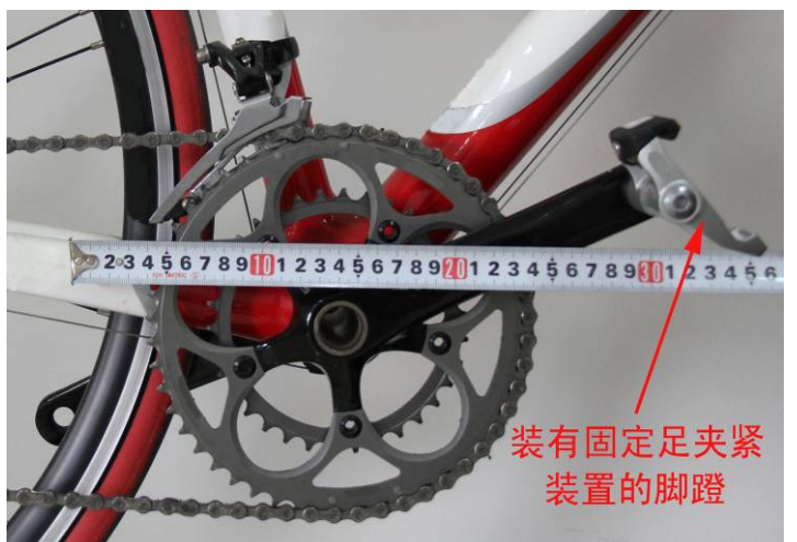
图五：符合国标 GB3565-2005 中 14.4 产品示意图
